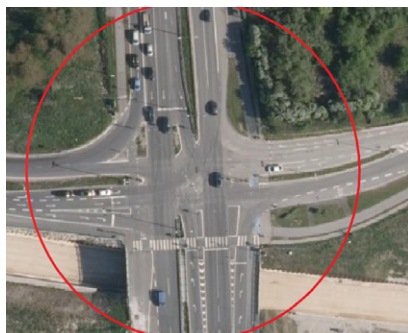
4-benet kryds (kode 1) trods shunt, svingbaner og stitilslutning.
